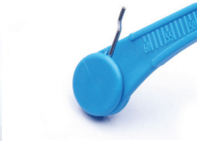
Prüfen, ob der Schlüssel den Anschlag am runden Griffende erreicht hat
